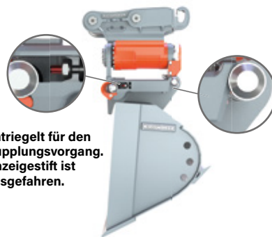
Nicht korrekt verriegelt Riegelbolzen sind über dem zugelassenen Bereich. Anzeigestift ist ausgefahren.
